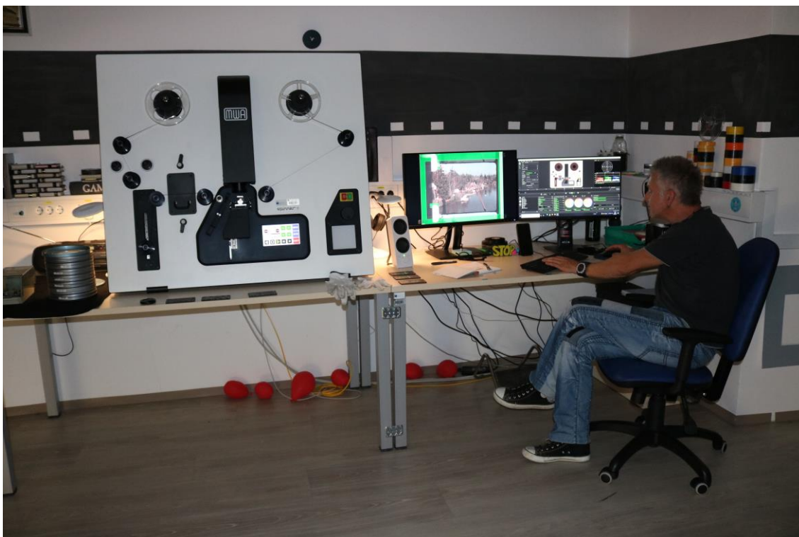
Slika 4: Naprava za digitalni zajem filmskega arhivskega gradiva Spinner-S s pripadajočo programsko opremo. Digitalizacijo izvaja Borut Jurca. Foto: Lucija Planinc
